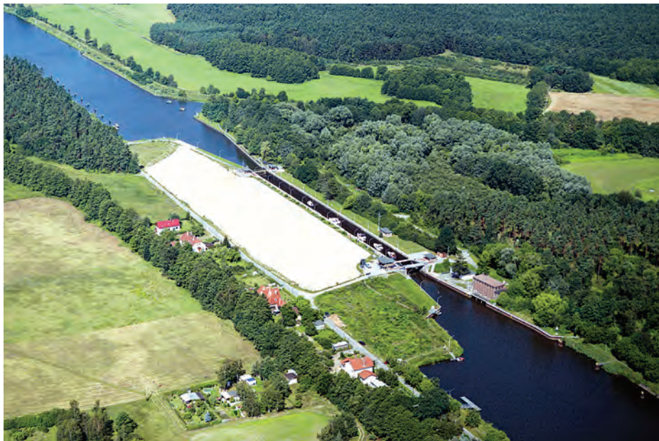
Schleuse Wusterwitz. Eine zweite Schleusenkammer ist links neben der vorhandenen geplant.
